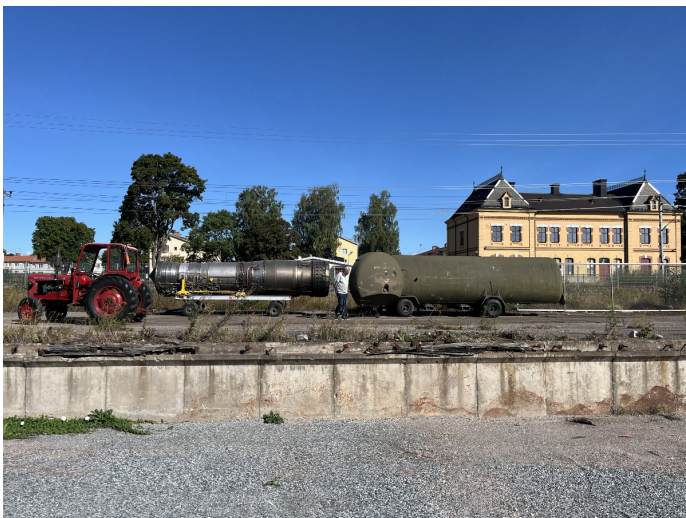
260811 RM8B-motorn uppkörd på lastkajen och redo för indockning i motorbehållaren
