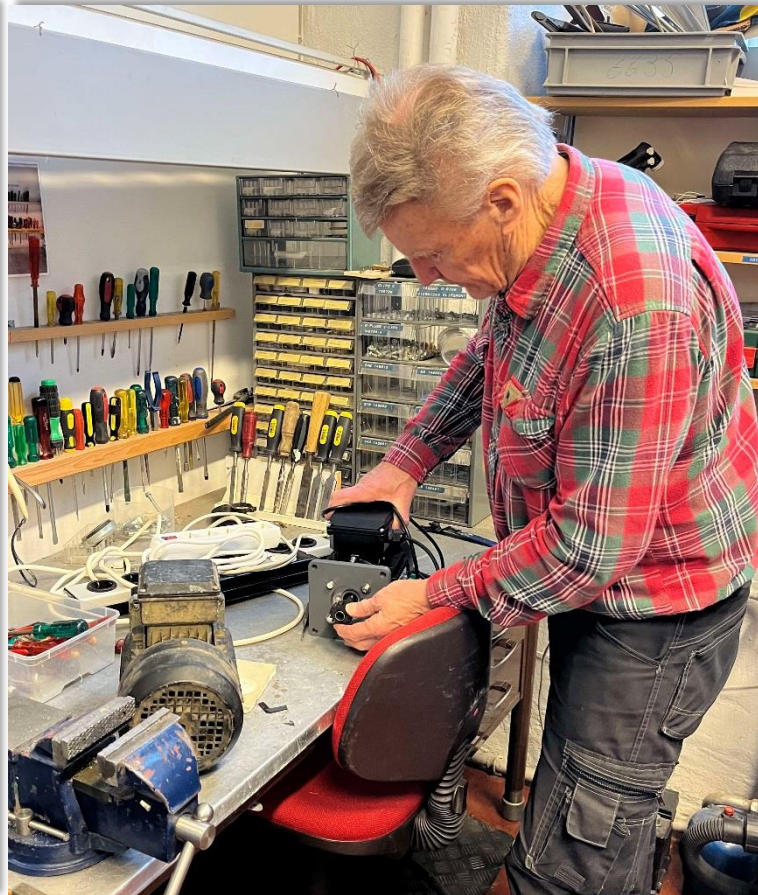
Antero kollar drevet på den nya 1- fasmotorn som är flyttad från den gamla motorn som ska driva PS-41 radarantennen.
