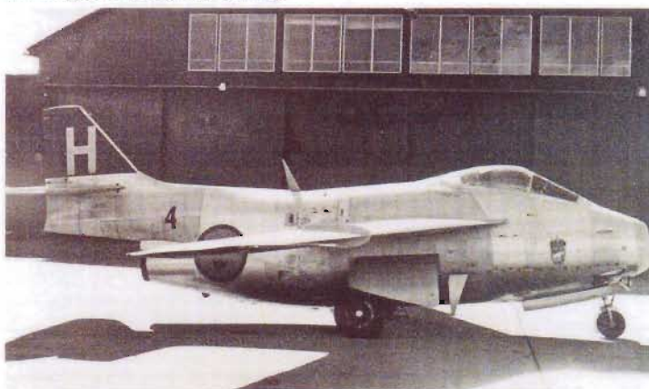
J 29E saknade efterbrännkammare, men hade nya så kallade såg-tandsvingar med den karaktäristiska stallfenan. 29 exemplar byggdes och fanns på F 4 på Frösön.
