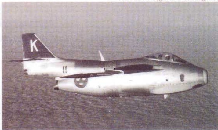
Spaningsversionen S 29C var obehäpnad. För att inrymma lod- och noskamerorna fick nospartiet sin karaktäristiska utformning. I stjärten finns en mottagarantenn för bakomvarnare. Annan skillnad är en vertikal antenn i luftintaget för avståndsmätning.
