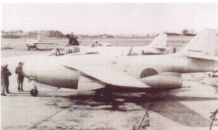
J 29D fanns bara i ett exemplar och användes för den av Svenska Flygmotor AB i Trollhättan framtagna efterbrännkammaren, vilken avsevärt ökade flygplanets stigningsförmåga.
