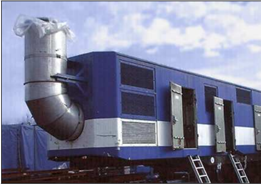
Mobil anläggning för elgenerering med hjälp av Proteus gasturbin
