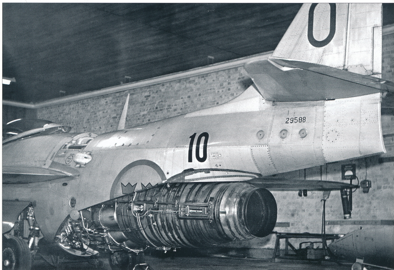
Jaktplan J 29F med motor RM 2B, som försetts med EBK. Effekten ökade med 25 %, vilket framför allt gav bättre stigprestanda.
