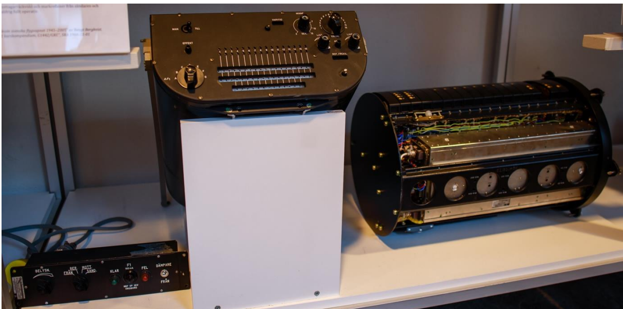
Apparat 91. Manöverpanel höger, Indikator och Mottagare (tillhör FVM)
