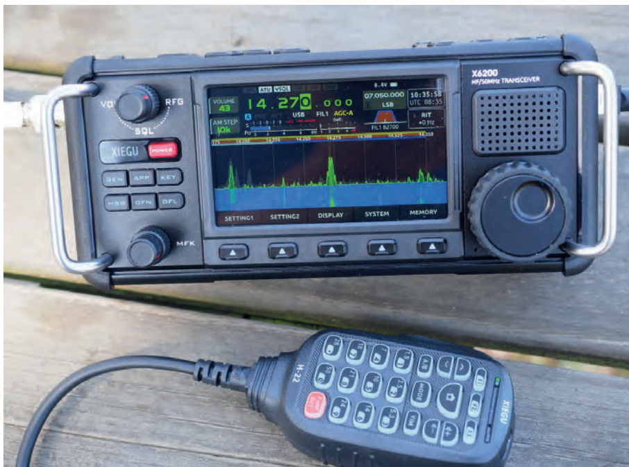
BILD 1: XIEGU X6200 framifrån visar tydligt att radion är robust och skapligt genomtänkt. Diverse knappar på framsidan och en stor och tydlig display. Högtalaren vänd framåt. Den medföljande mikrofonen hjälper vid bandval, mode och diverse annat om man inte vill leta efter dessa funktioner på radions ovsida.
