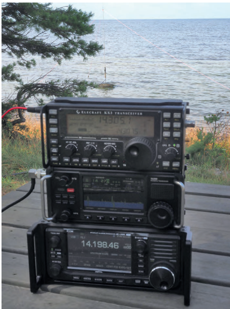
BILD 2: Att stapla tre QRP-småttningar på varandra och göra A/B/C-test är riktigt lyxigt och intressant. X6200 är den nyaste i denna trio. Den är billigare än de andra och ger mycket goda prestanda. Uppifrån och ner ser vi Elecraft KX3, XIEGU X6200 och Icom IC-705. I bakgrunden ser den skarpögde en vertikalantenn som är placerad ute i Östersjön.
