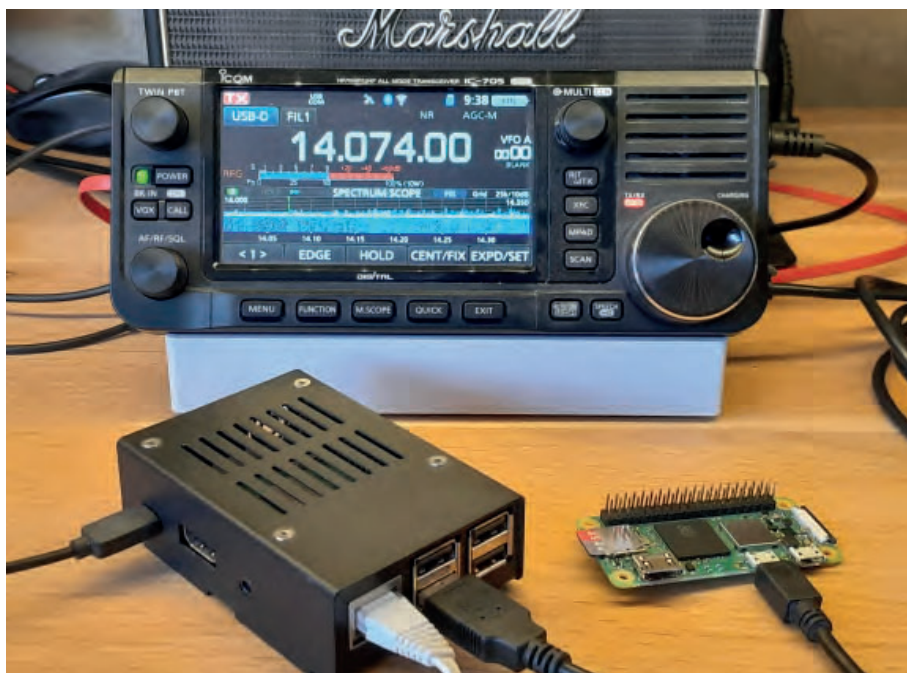
BILD 1: Här är allt som behövs (och lite till) för att kunna köra DigiPi. En radio med USB-snitt och Raspberry Pi. I bilden finns även den billiga Pi Zero 2W som gör sitt jobb för den som kan kompromissa.
