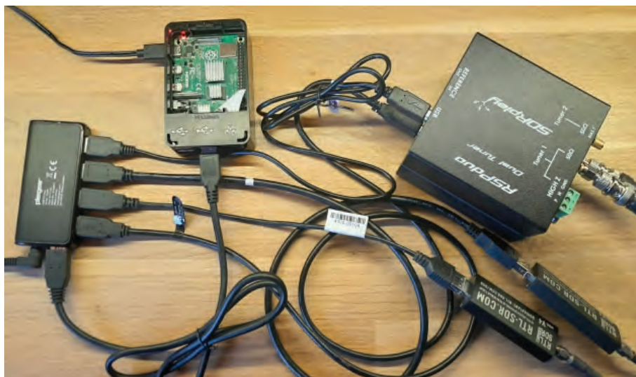
BILD 1: Så här ser det ut hos SMOJZT då detta skrivs. Två stycken RTL-SDR-pinnar och två SDRPlay-mottagare är kopplade till en Raspberry Pi via en USB-hub med egen spänningsmatning.
