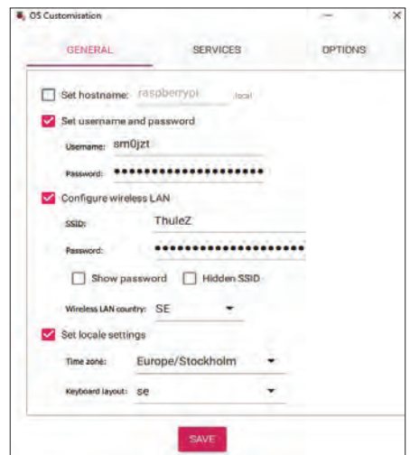
BILD 4-6: Installationen av Operativsystemet på RPi:n microSD-kort sker med "Imager-programvaran. En del konfigurationer behöver göras här så att man kan använda RPi:n för driftsättningen.
