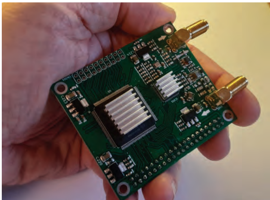
BILD 1: Här har vi handen full med ett Radioberry-kort. Som man kan se så är det idel ytmonterat på kortet. Den stora kretsen är en FPGA som behöver kylas av då mycket försiggår under huven.
