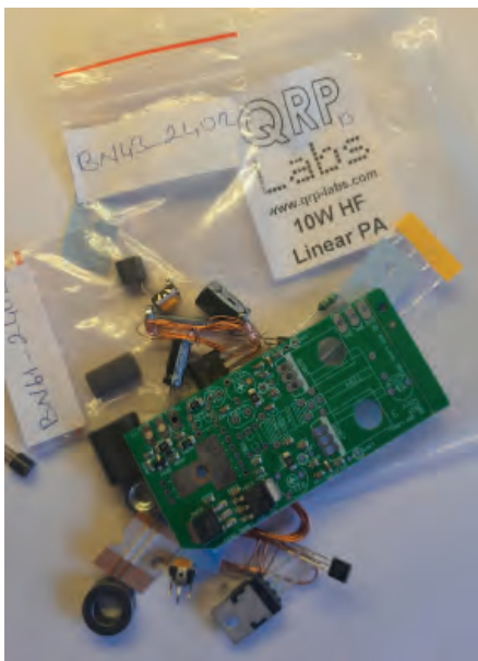
BILD 10: Om 10 mW uteffekt känns för lite (vilket man kan anta) så går det fint att bygga ett litet PA för att som detta få ut ungefär 10 W. QRP-labs har en byggsats för 26 USD ex frakt.
