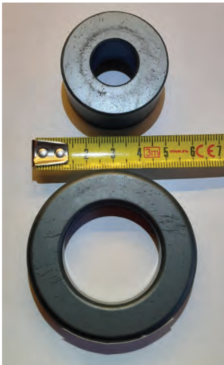
BILD 2: Här en bild på de två stora kärnorna som används. Den undre är FT240-43. Den övre är "kabelfilter"-ringen som är mindre i diameter men istället tjockare. Ferritmaterialet är mycket skört och tål inte slag. Tappar man en ring på ett hårt golv kan man vara ganska säker på att den spricker och därmed blir obrukbar.
