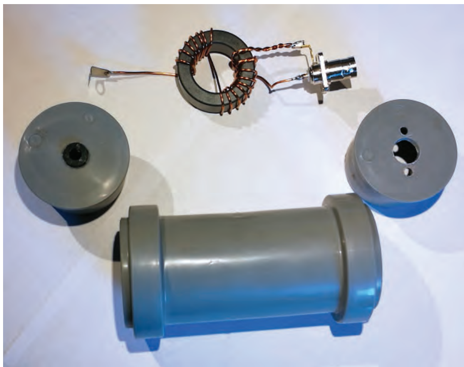
BILD 5: Här en unun med den lilla FT140-kärnan. Eftersom kärnan är blott 35 mm i diameter får den plats inuti en ”avloppsmuff” på 40 mm. Avslutningspluggar sätts i ändan och så man en tät och fin lösning. En ordentlig kapsling är inte bara bra för att hålla fukten borta. I portabelsammanhang kan det vara bra att ha kapslingen som fallskydd.
