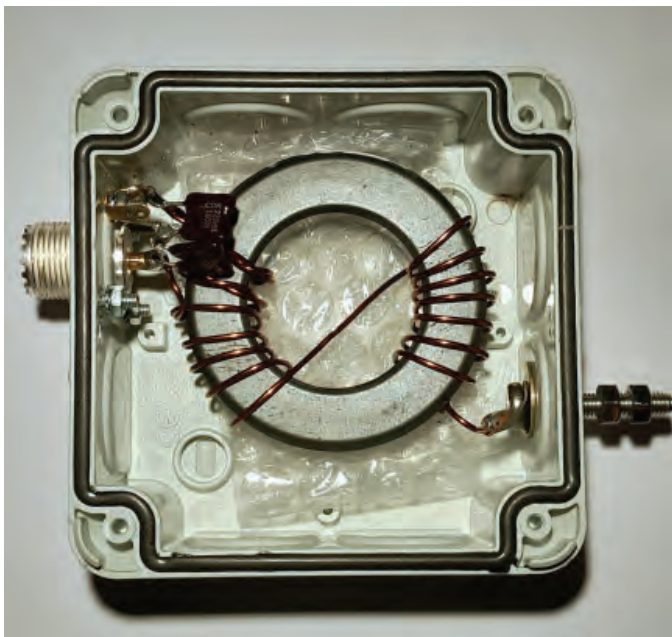
BILD 3: Här har ununen med FT240-kärnan placerats i kopplingsdosa. Uppe till vänster i bild ser man två 220 pF-kondensatorer med 1 kV tålighet har seriekopplats och sedan monterats över koaxialkontakten. Vi får då en kondensator på runt 100 pF med 2 kV tålighet. Bubbelplasten under kärnan är till för att kärnan inte skall skramla runt i lådan.
