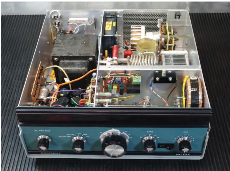
BILD 1: Så är snyggt är ett SB-230 framifrån. Läger man ner en hel del krut på innanmätet så blir steget bra mycket bättre och framtidssäkert än originalet. Det enda som är "nästan" orört är högspänningsdelen till vänster i bild. Till höger finner vi den nya glödtrafon (ringkärna).
