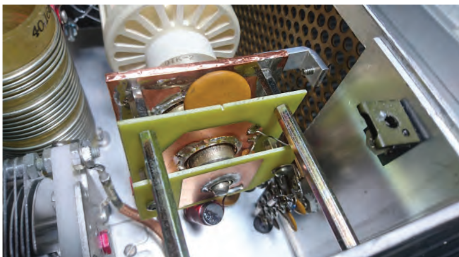
BILD 5: Närbild på den egentillverkade rörsockeln. En hel hoper distanser, lämpliga kretskort, kopparplatta och fingerstock behövs/krävs för ett fungerande och snyggt resultat.
