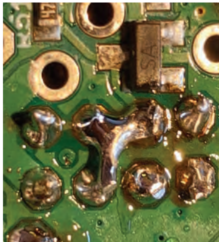
BILD 4 & 5: Även en rutinerad ”lödare” kan ställa till det för sig. Det är trångt om saligheten och du kan inte ha hur smal lödspets som helst. Här har det gått livat till. Men med en tennsug och lite goda nerver så blir det riktigt fint.
