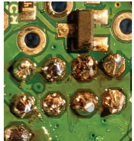
BILD 4 & 5: Även en rutinerad ”lödare” kan ställa till det för sig. Det är trångt om saligheten och du kan inte ha hur smal lödspets som helst. Här har det gått livat till. Men med en tennsug och lite goda nerver så blir det riktigt fint.
