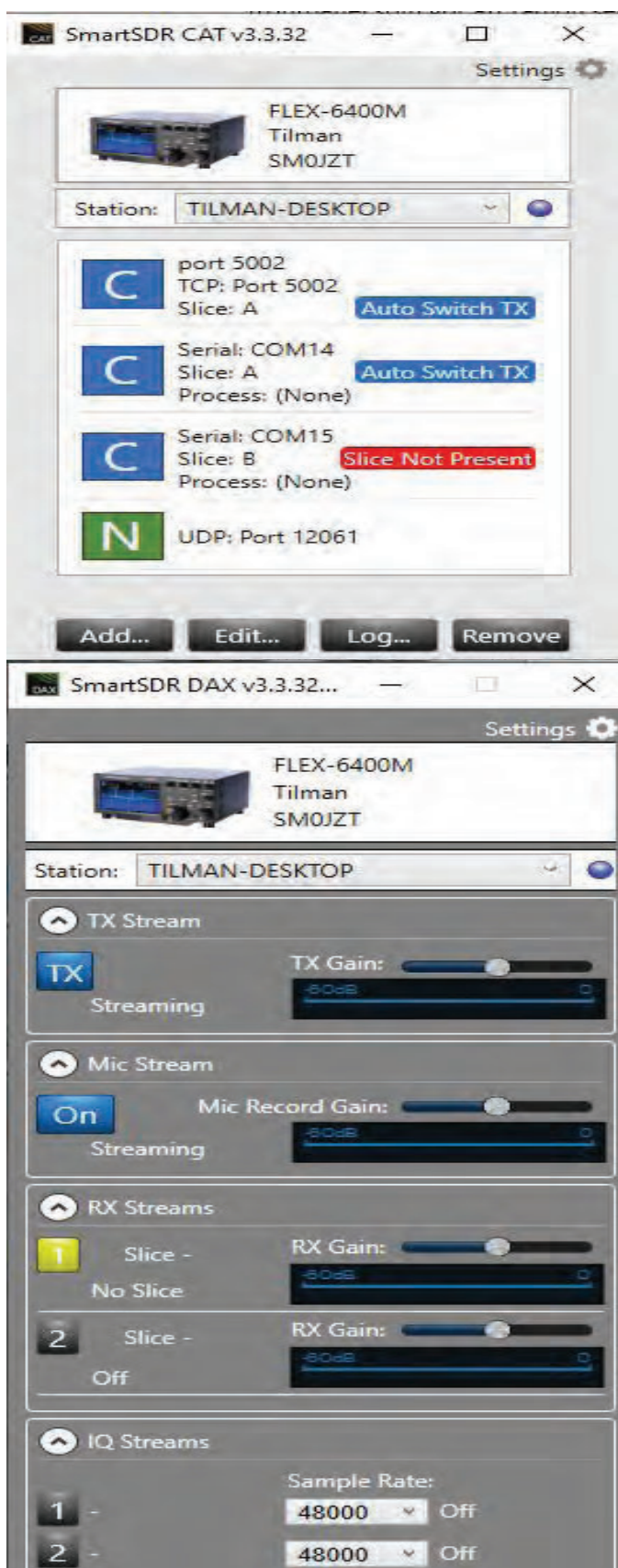
BILD 5 - 6: För tilldelning av virtuella styrkanaler respektive ljudkanaler till andra applikationer med en FlexRadio 6000 använder vi SmartSDR CAT respektive DAGS. Med tungan rätt i munnen och studium av den utmärkta dokumentationen går det som en dans.
