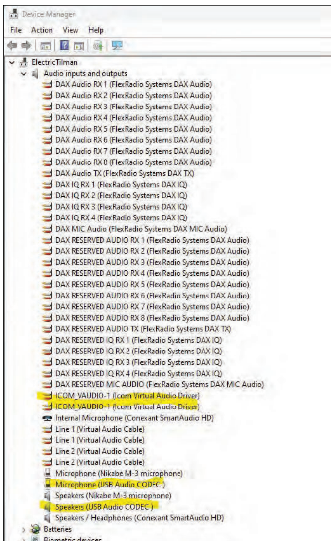
BILD 2-3: I enhetshanteraren/devicemanager finner vi information om de virtuella ljudkanalerna (audio) respektive kommunikationskanaler (COM-port) som tilldelats PC:n från radion. Det är en individuell tilldelning från system till system.
