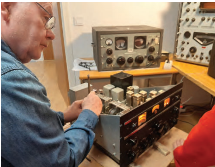
BILD 8: Dags att trimma in det sista. SM5MRQ trimmar finkänsligt in så att radion hamnar rätt i frekvens. Håll med om att fronten på en AR-88 tillhör de snyggare. I bakgrunden finner vi Hammarlund och Racal-mottagare.
