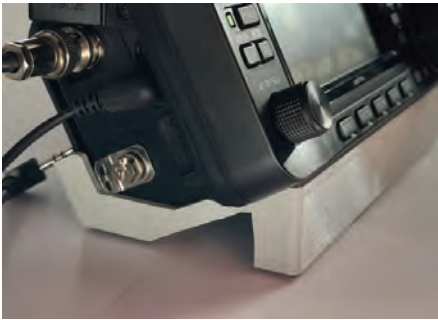
BILD 2: För att radion skall stå stadigt på underlaget kan man göra en lämplig "fot" med en 3D-skrivare. Finns att köpa färdig också för några hundralappar. Rekommenderas varmt.
