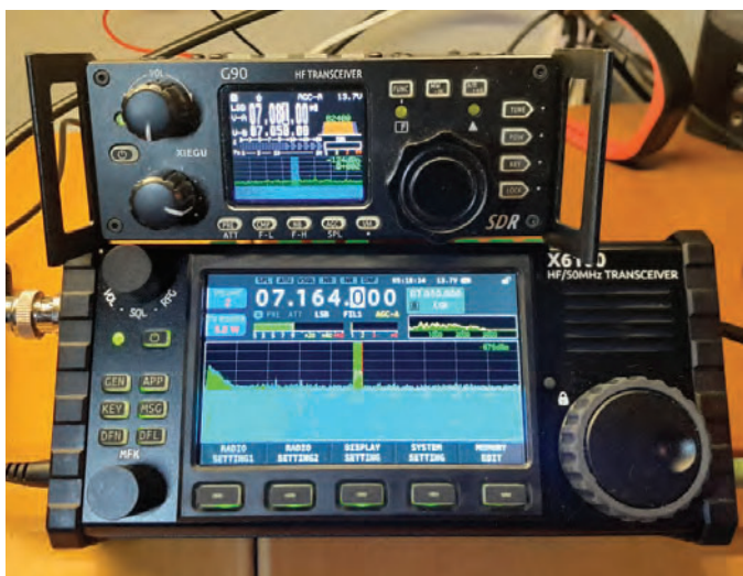
BILD 2: Det är frestande att jämföra X6100 med föregångaren G90 från XIEGU. Formfaktorn skiljer en del till X6100 fördel, framförallt i fält. G90 behöver stöd för att komma upp sig.
