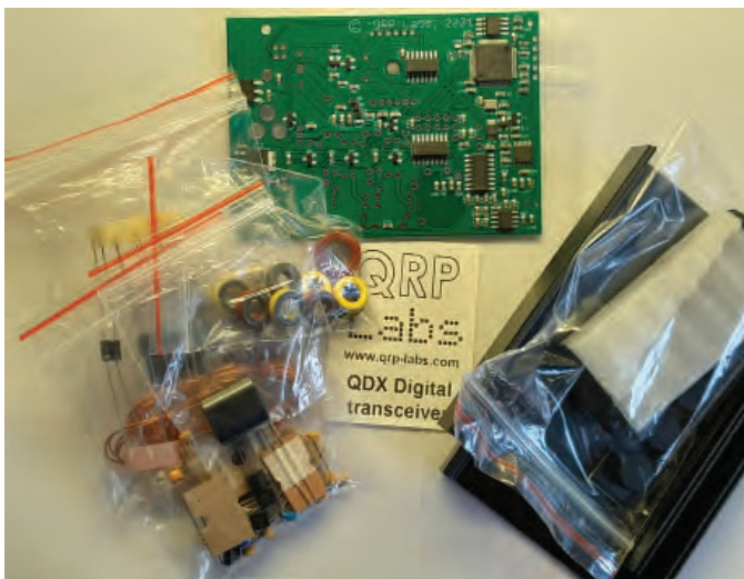
BILD 2: En liten kartong med byggdelar är vad som kommer för byggsatsen. Till höger bild delarna till den lilla aluminiumlådan som kan köpas som extra. Rekommenderas varmt för ett snyggt och komplett bygge.
