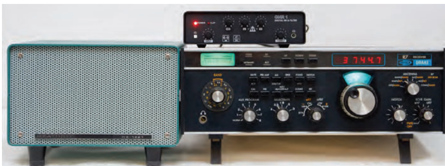
BILD 3: Så här kan det se ut när man kopplar in en gammal trojänare i form av en Drake R7 till XIEGU GNR1. Som framgår av bilden får en Heathkit-högtalare leverera förstärkt och filtrerad signal, en elegant kombination.
