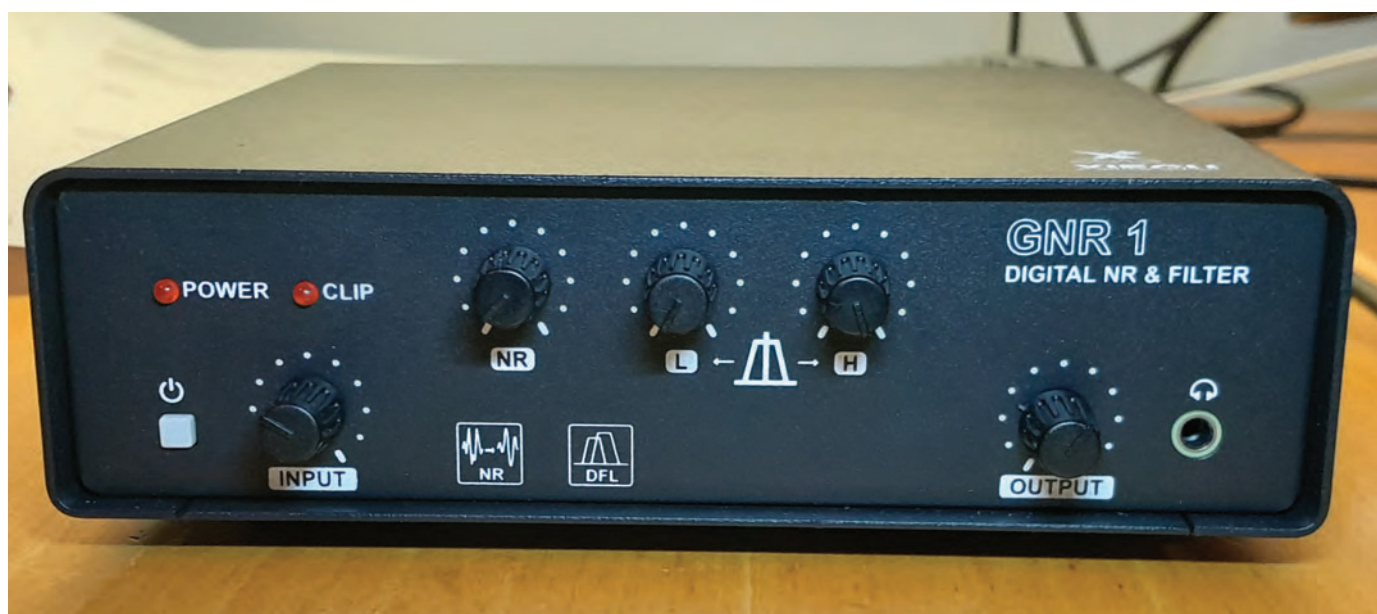
BILD 1: XIEGU GNR1 kommer i en stadig metallåda som inger förtroende. Tydliga knappar ger en indikation om deras funktion.
