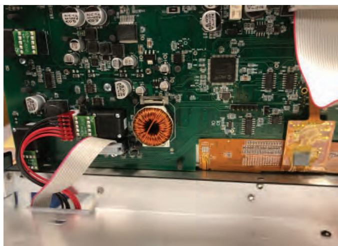
BILD 6: Radion är prydligt uppbyggd, men det finns risk för trubbel och lös bandkabel.
