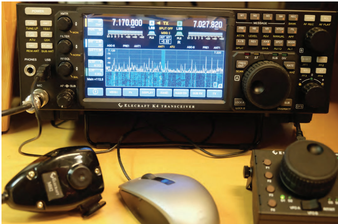
BILD 1: Så här ser frontpanelen på K4 ut i verkligheten. Här med lite kringutrustning som mikrofon och externa kontrollers – exempelvis en vanlig PC-mus via USB-snitt.
