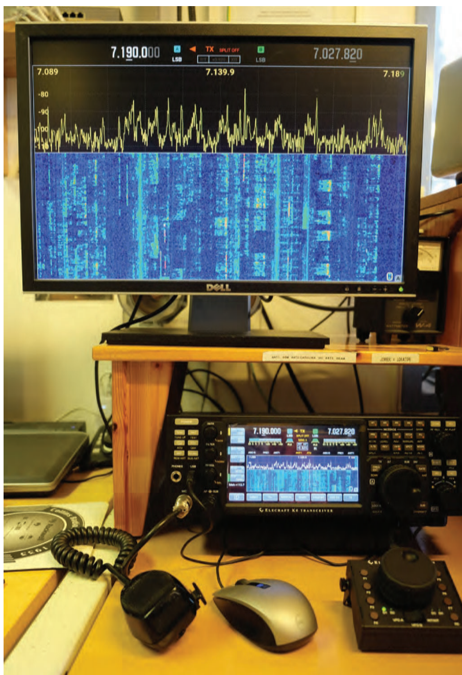
BILD 2: Här skiljer sig Elecraft sig rejält från konkurrenterna när man kopplar in en extern skärm. Informationen på den externa skärmen är inte bara en kopia av radions. Här kan den externa skärmen äntligen göra nytta.
