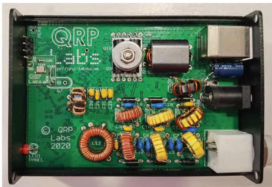
BILD 3: Komponenterna på kretskortets ovansida är de man behöver montera. På undersidan sitter det en hoper ytmonterade komponenter som är fabriksmonterade.
