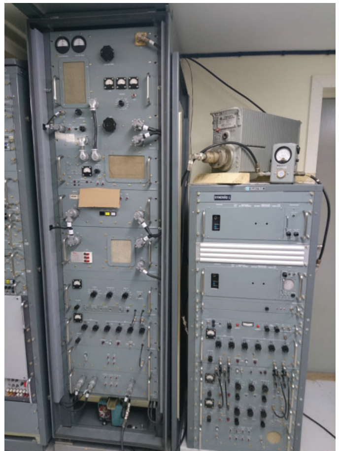
BILD 7: Det tunga artilleriet för kortvåg fick utgöras av en CT-1000 från Standard Radio. Flera hundra kilo kvalitetsprodukt syns här. Sändaren till vänster och en mottagare till höger i bild. Imponerande bygge hemma hos SM5LQL Kent.
