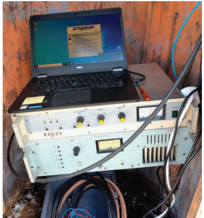
BILD 4: FM-sändare på 300W står med en PC kopplad till Internet lite på sned i ett gammalt skyddsvärn på Kastellet's torn.
