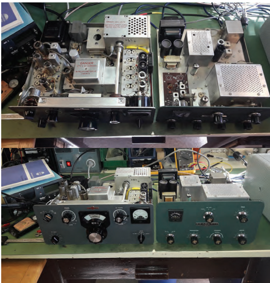
BILD 4: Collinstransvertern har på bilden fått sällskap av den tidstypiska transvertern SB-500 från Heathkit. Man kan se att designen påminner i alla fall till det yttre ganska mycket om varandra.
