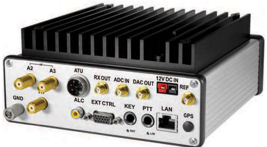
BILD 4: På baksidan av "radion" finner man bland annat dom lite udda Mini-UHF-kontakterna för inkoppling av antenner. Andersson PowerPole används för DC-matning.
