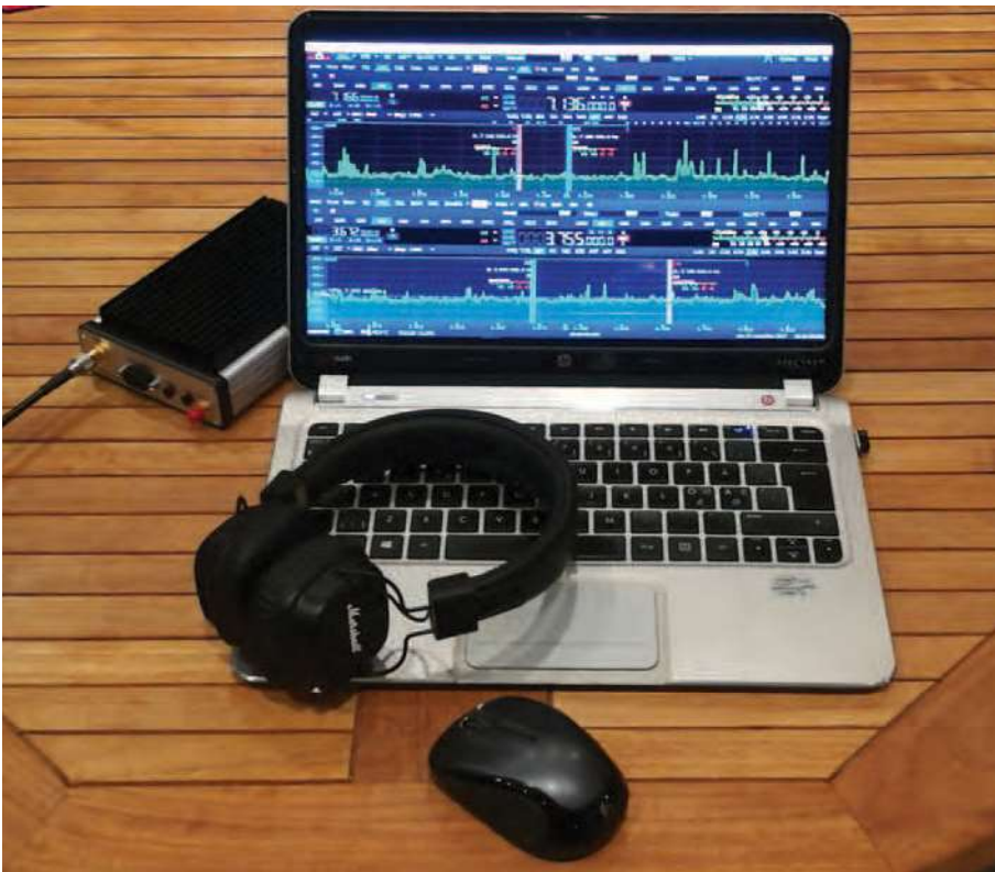
BILD 2: "Operatörspanelen" till en SDRadio från Expert Electronics ser udda ut. På bilden ser man en QRP-version av den omskrivna radio. Radiodelen måste inte likt bilden vara ens i närheten, den kan stå på en helt annan plats.
