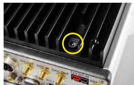
BILD 5: Vid kylflänsen finns en liten kontakt för inkoppling av extern kylfläkt. Det är en mycket bra och viktig finess för att radion skall hålla "huvudet kallt".
