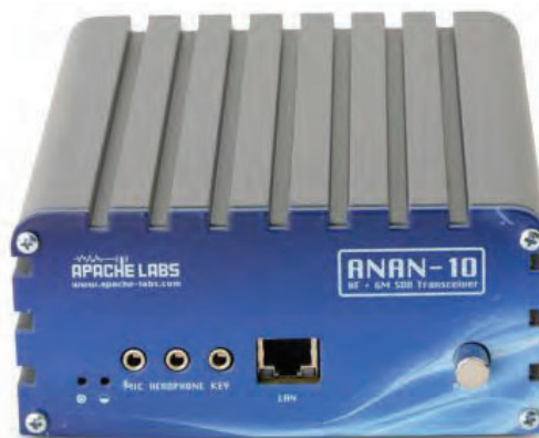
BILD 2: Apache-Labs gjorde en Hermesbaserad rigg som kan sägas vara "originalet". Den tillverkas inte längre, men använts med framgång hos SMOJZT.
