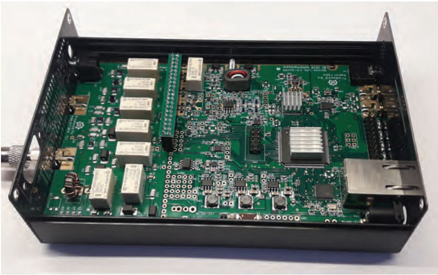
BILD 3: Under locket ser man huvudkortet (till höger) som kopplats samman med filterkortet till vänster. Gott om kontakter möjliggör inkoppling till omvärlden.
