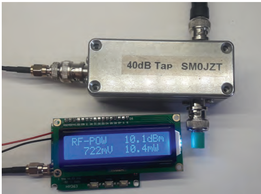
BILD 1: Så här ser modulen ut inkopplad och med inkopplad 40 dB tap för att mäta max 10 W. Effektmodulen har programmerats för att visa rätt mätvärden, med hänsyn taget till 40 dB. Här visar ett mätvärde av 10,1 dBm, motsvarande 10,4 mW och 722 mV.
