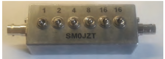
BILD 4: En gammal bekantning bland mätmojängerna. En variabel dämpsats som är uppbyggd med enkla omkopplare och ytmonterade motstånd.
