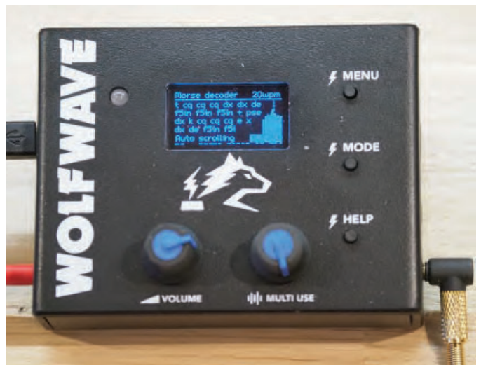
BILD 2: Som en liten extrafiness kan enheten koda av CW-signalerna. Riktigt effektiv när man ställt in rätt läge. Hade gärna sett en större display till detta också.
