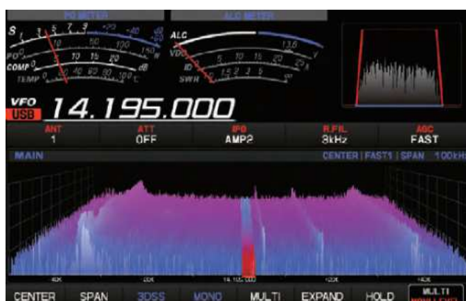
BILD 6. Här tittar vi på det tredimensionella spektrumet på blott ett band. Man kan exempelvis ser hur stationen till vänster i bilden blivit starkare över tid. Ur YAESU-broschyr.
