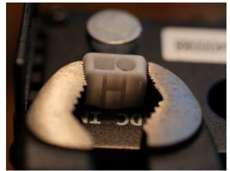
BILD 4: Närbild på original DC-kontakten när den tas bort. Pressa in låsspärrarna med en polygrip och tryck ut den bakåt med tummen.
