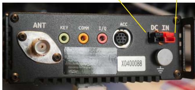
BILD 3: När man sågat och slipat till chassieflänsen för BNC-kontakten och monterat den så ser det riktigt fint ut. Här ser man även hur Anderson Powerpole-kontakten har fallit på plats. Tittar man riktigt noga så ser man koppartråden som läser DC-kontakten så att den inte far in i radion.
