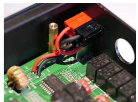
BILD 6: Så här ser det ut inifrån radion när kontakten är monterad. Var noga med arbetet så ser det bra ut.
