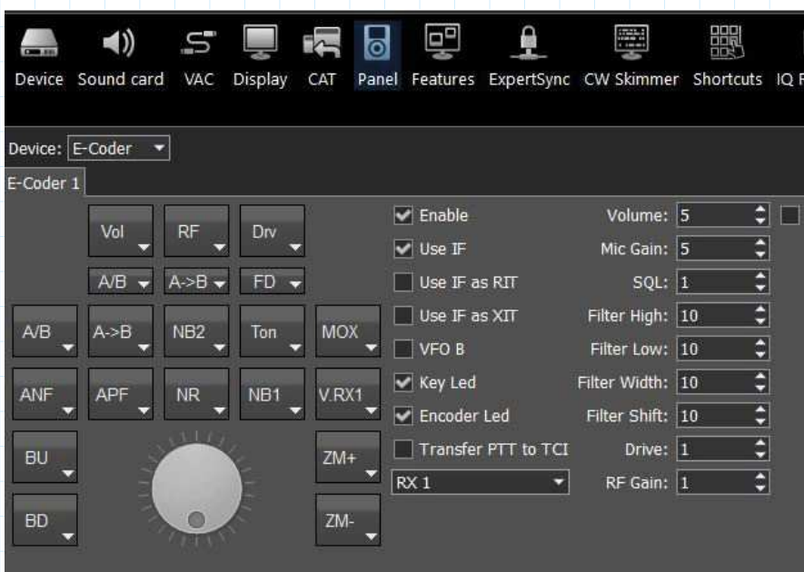
BILD 8. E-coder från Expert Electronics kopplas in via USB till PC:n och konfigureras i "Panelmodulen". Knapptopparnas text kan modifieras lätt.
