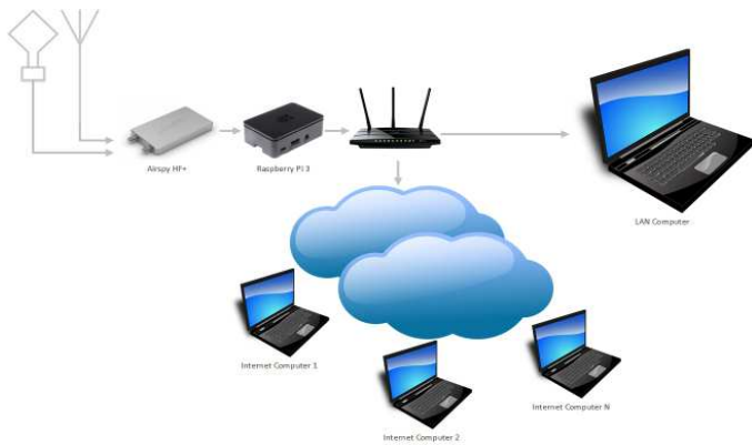
BILD 9. Så här hänger bitarna ihop med en spysserver. Airspy HF+ kopplas till en spysserver (i detta fallen Raspberry Pi) som via en "bredbandsrouter kopplas till nätet. Multipla användare kan så använda samma mottagare inom ett gemensamt spektrum av 660 kHz.
