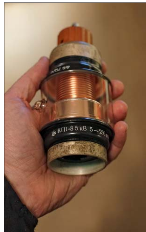
Bild 4, en prydlig pjäs från landet i öster. En vridkonding som har 5 till 260 pF variabelt. Genom att kondingen är innesluten i vakum klarar den av 5 kV spänning. Man får rota flitigt på surplussmarkanden efter dessa skönheter.
