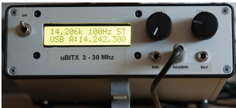
BILD 2 , en bild i repris från tidigare artikel. Ger en överblick på hur fronten kan se ut i en Hammondlåda. Som man kan se så har en vanlig vippkopplare används för att slå på och av spänningsmatningen. Notera placering av övriga manöverorgan. Displayen skruvas fast med försänkta skruv (hade bara svarta hemma). Hålet till displayen måste placeras noga.
