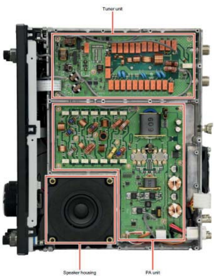
Bild 6, oöversidan på radion under huven visar uteslutande analoga delar. Överst antennenpassaren därunder slutsteg (100 W) och dom därtillhörande lågpassfiltrena. Högtalaren gör ett ok jobb. Externa lurar eller stereohögtalare är mycket bättre.
