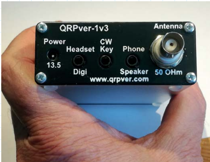
BILD 2: Alla kontakter har vi på baksidan. Från vänster spänningsmatning med en DC-plugg om 3,5 mm diameter. Helt till höger BNC-kontakt för anslutning till antennen.
