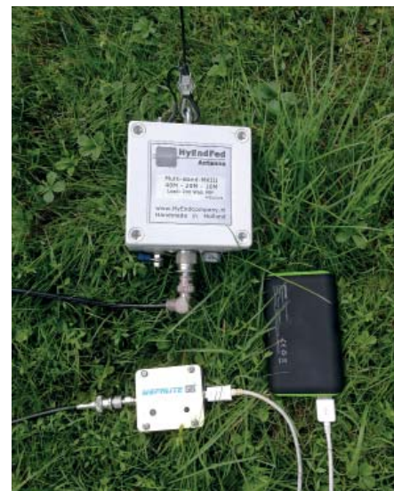
WSPRLite uppsatt för fälttest. 5V spänningsmatning från en "powerbank" och kopplad till en ändmatad antenn.
