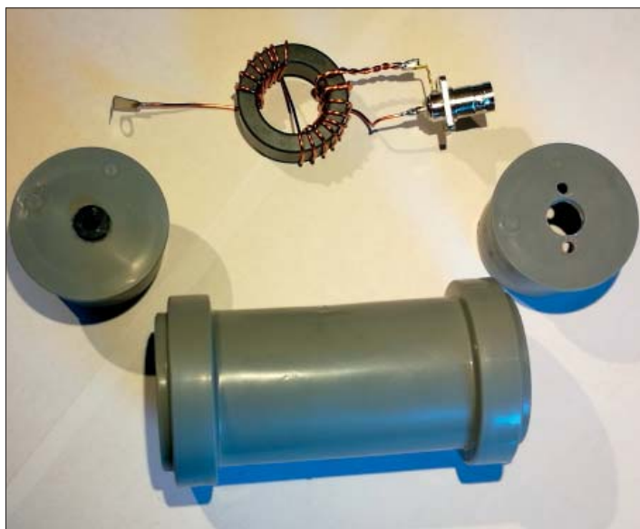
Bild 8 – Här ser man den färdiglindade toroiden färdig att monteras in i lämpligt hölje. Se till att linda snyggt och prydligt så blir du riktigt belönad med funktionen.
