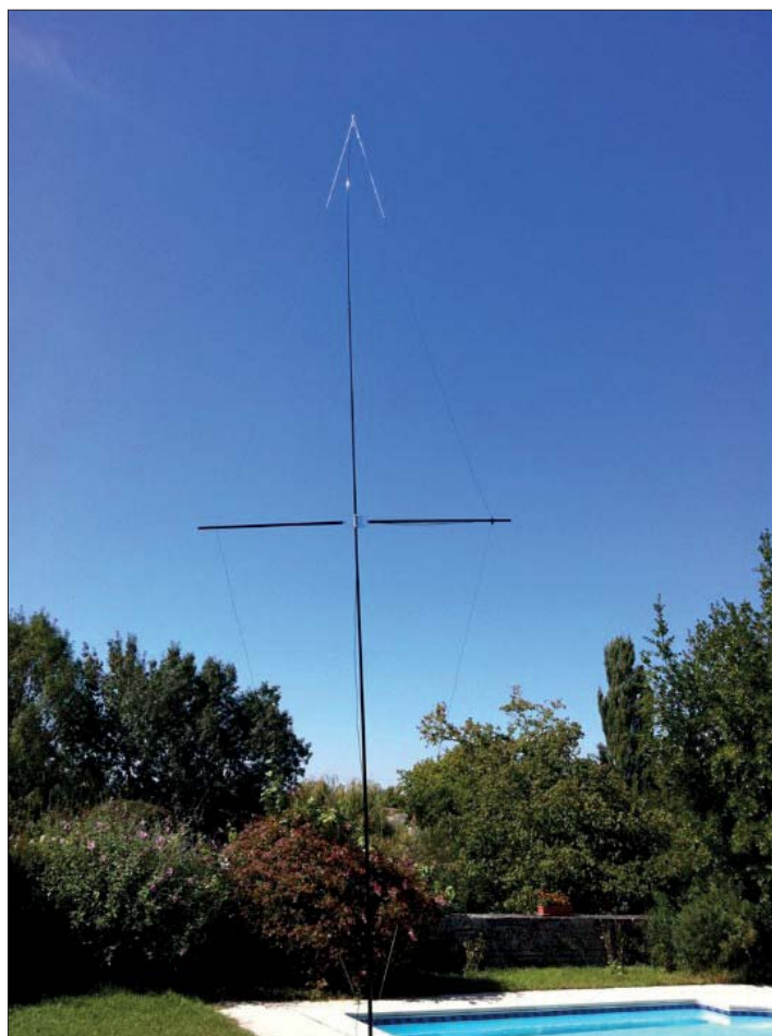
Bild 4 – Så här ser det färdiga resultatet ut. Antennen byggs vanligtvis kring en teleskopisk mast. Som synes kommer antennen långt ner, vilket kan vara praktiskt. Någon motvikt behövs inte eftersom antennen bygger på halvvägsselement. Men extra bra "takeoff" får man då man har hög markkonduktivitet som exempelvis en pool eller salta hav...
