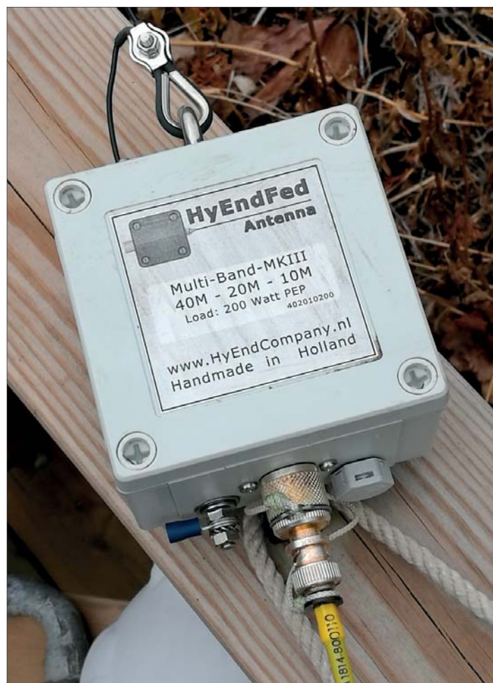
Bild 1. Handmade in Holland. Mycket god kvalitet på alla komponenter, rostfria skruv och beslag. Här lådan som innehåller den UNUN med anpassning för det korta 11,85 meter långa antennelementet. Koaxmatningsledningen kopplas en SO239-kontakt. Personligen föredrar jag BNC, därav adaptern.
