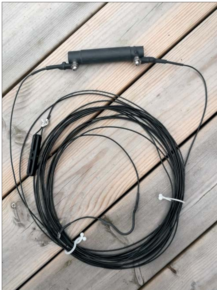
Bild 2. Här har det 11,85 meter långa antennelementet tagits loss från lådan. Notera förlängningspolen som ger ett elektriskt halvvågselement för 40 meter. Även detta mycket elegant gjort med krympslang här och var.
