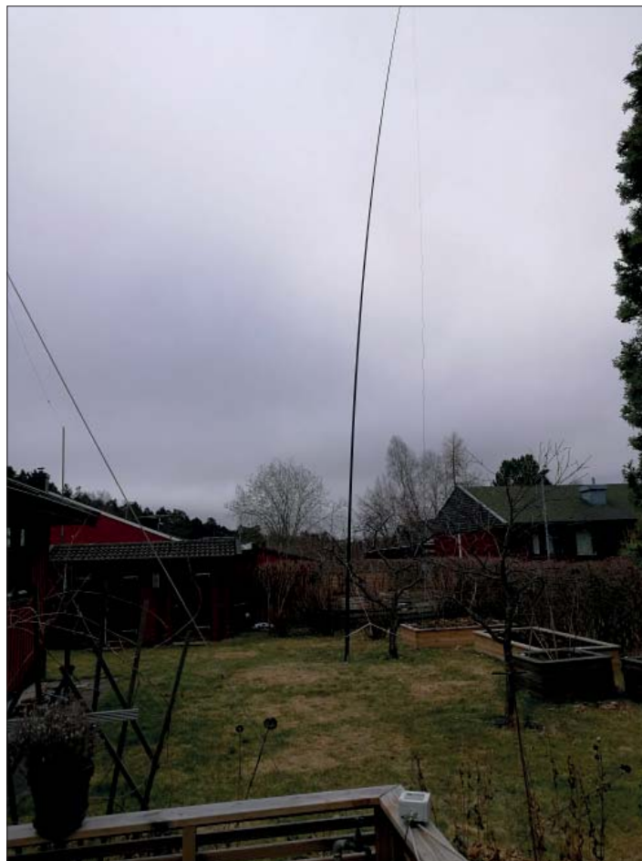
Bild 3. En 18 meter lång teleskopmast passar utmärkt som enda upphängningspunkt, framförallt då man använder det 20 meter långa elementalternativet. Här har masten knutits provisorisk till ett plummonträd i trädgården. Ett örnöga krävs för att se tråden som består av stark isolerad tråd från DX-Wire. UnUn-lådan syns liggandes på altanracket nedan i bild.
