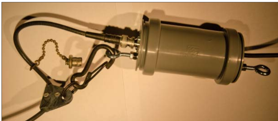
Här är strömbalunen klar. Notera hur antennens koaxdel anslutes dragavlastat med kroken till vänster i bild. Den uppmärksamma noterar att diverse militärsurplus har kunnat återbrukas. Ögla till höger på balunen används för att koppla en draglina.
