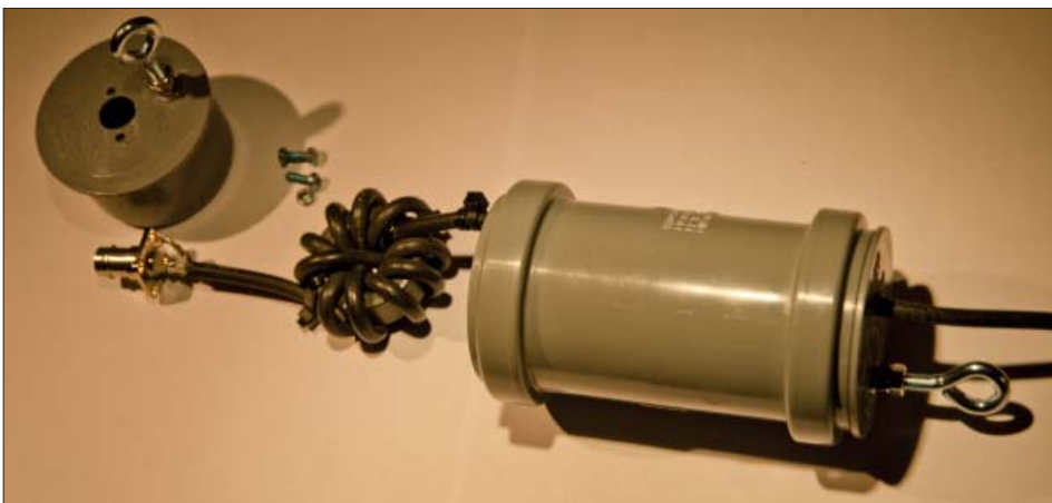
Strömbalunen är klar att montera i sin skarvmuff (50 mm). Notera att det är lite trångt att få in 10 varv (2 x 5) på ringkärnan. BNC-kontakten skruvas fast med två skruv och dragögglor monteras bortom lockets mitt så att balunen hänger ned och eventuellt vatten kan tränga ut genom litet hål i muffens botten. Försegla gärna koaxingången med exvis varmlim. På bild har stoppskruv ännu ej monterats för att stoppa locken från att glida ur muffen.
