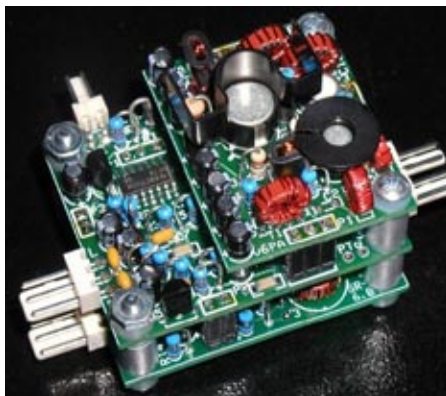
Här bild av Softrock version 6 med exiter och slutstegsmodul på ca 1 watt. Bild: NIRX
