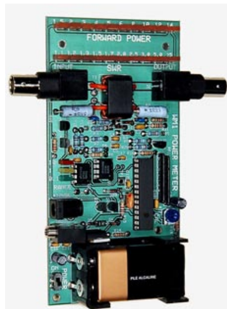
Den nya modulen W-1 i Elecraft Mini-modules"-serien. En enkel men intelligent effektmätare i byggsats. Bild: Elecraft
