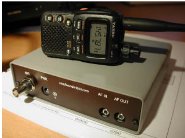
PSK20 är liten (14x14x4cm). Men vid sidan om den lilla VHF/UHF-handapparaten (också QRP) är den en jätte.
