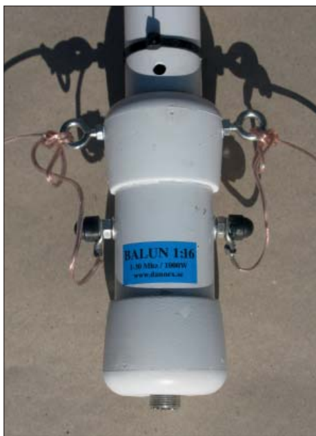
Det är roligare om man gör balunen själv. Denna gång fuskade jag med en färdig robust balun från svenska Dannex. En bra inkapsling är viktig så att funktionen består över tid.
