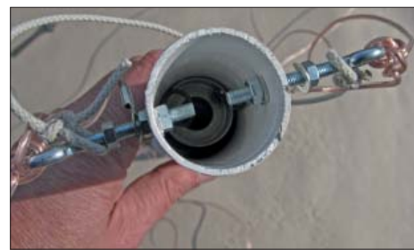
Avslutningsmotståndet placerad jag i VVS-röret. Kanske hade det varit bra med lite mera plats för luftväxling.. men jag kör ju nästan bara QRP. På med locket så man håller väder och vind ute.
