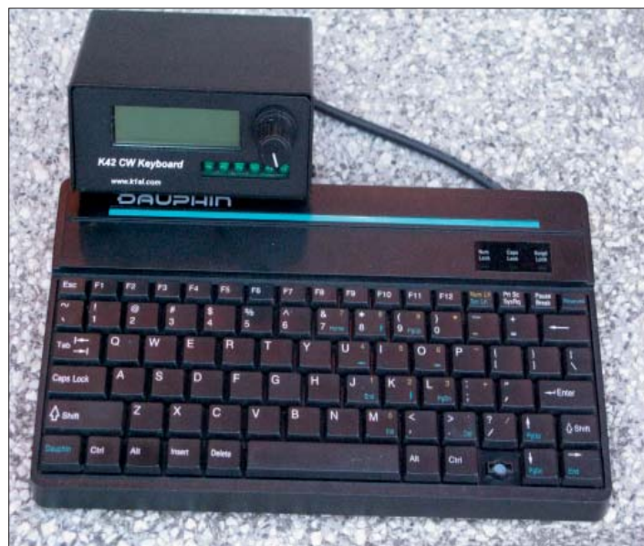
Här ses den färdiga K42 tillsammans med ett litet tangentbord (24cm brett) färdig att brukas.
