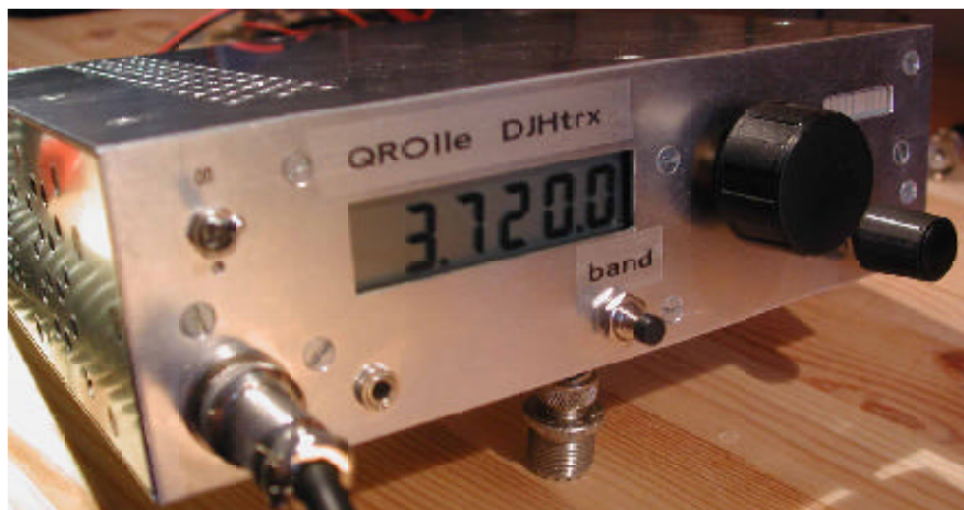
Här en bild på prototypen till den Svenska QRP-riggen för 20/80 meter. Trots mycket goda data är handhavandet enkelt och funktionellt. Bild: SM0JZT
