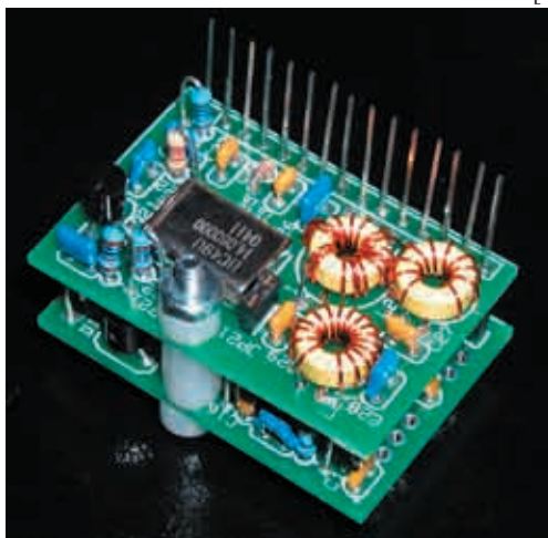
Här en bild på Version 5 av softrock. Den består av ett kort för QSD:n och ett för "VFO:n".
