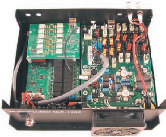
SDR-1000 - En svart låda?? Magin sitter dock i mjukvaran i en PC. Till höger ett 100W PA med lågpasfilter. Till vänster QSD:n och bandpassfilter.
