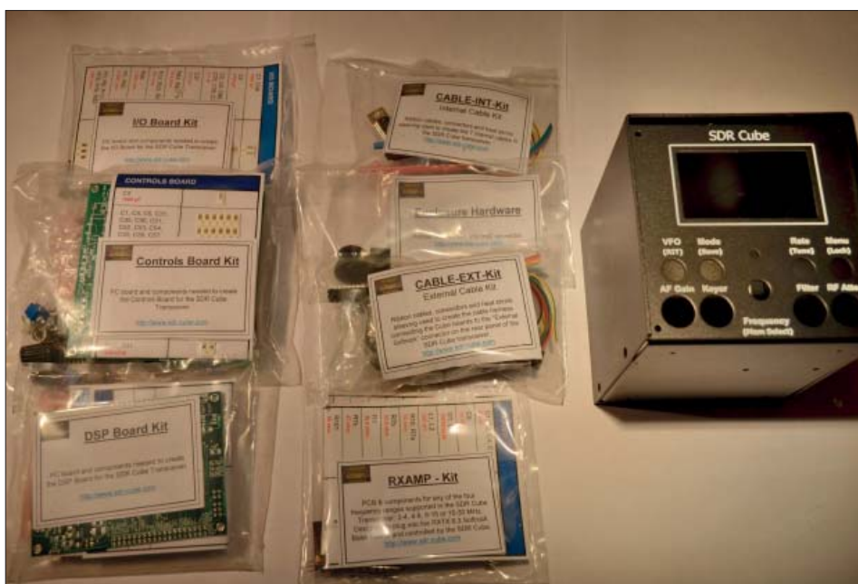
Byggsatsen till SDR-CUBE kommer pryligt förpackade i separata påsar, en för varje beställd modul. Jag har valt att bygga min SDR-Cube själv, men det finns även färdigbyggd.
