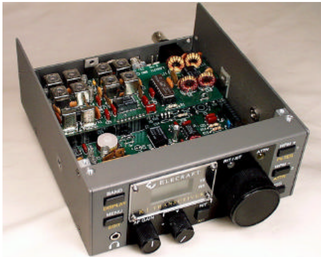
Lillebror K1 är en mycket kompetent CW-rigg. Här med en tvåbandsmodul. Mått 6 x 13 x 14 cm – Bild: Elecraft
