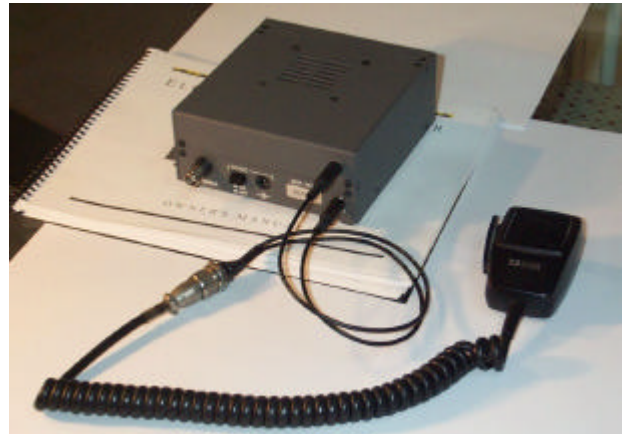
Två kontakter på riggens baksida kopplar in mikrofon eller ljudkort i PC för digitala moder. Bild: IOCG
