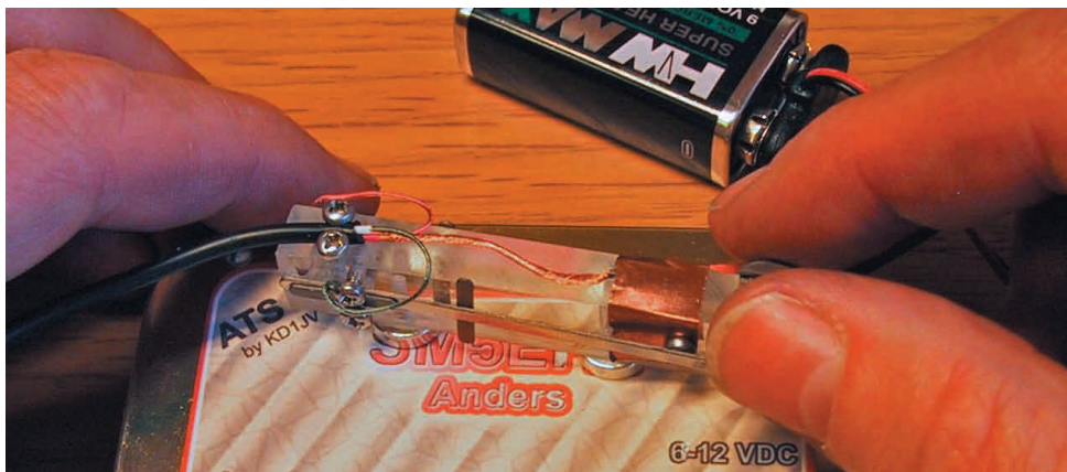
En passande manipulator sitter här med magneter på riggen. Konstruktionen är inte bara liten och nätt. Den är lätt justerbar och inte minst kostar den inte mycket att göra själv.
