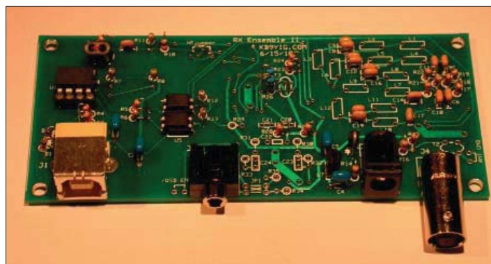
Här en SoftRock ensemble II under uppbyggnad. Den skall användas som en av flera mottagare hos SM0JZT. Att använda av radioamatörer över hela världen för att göra experiment.
