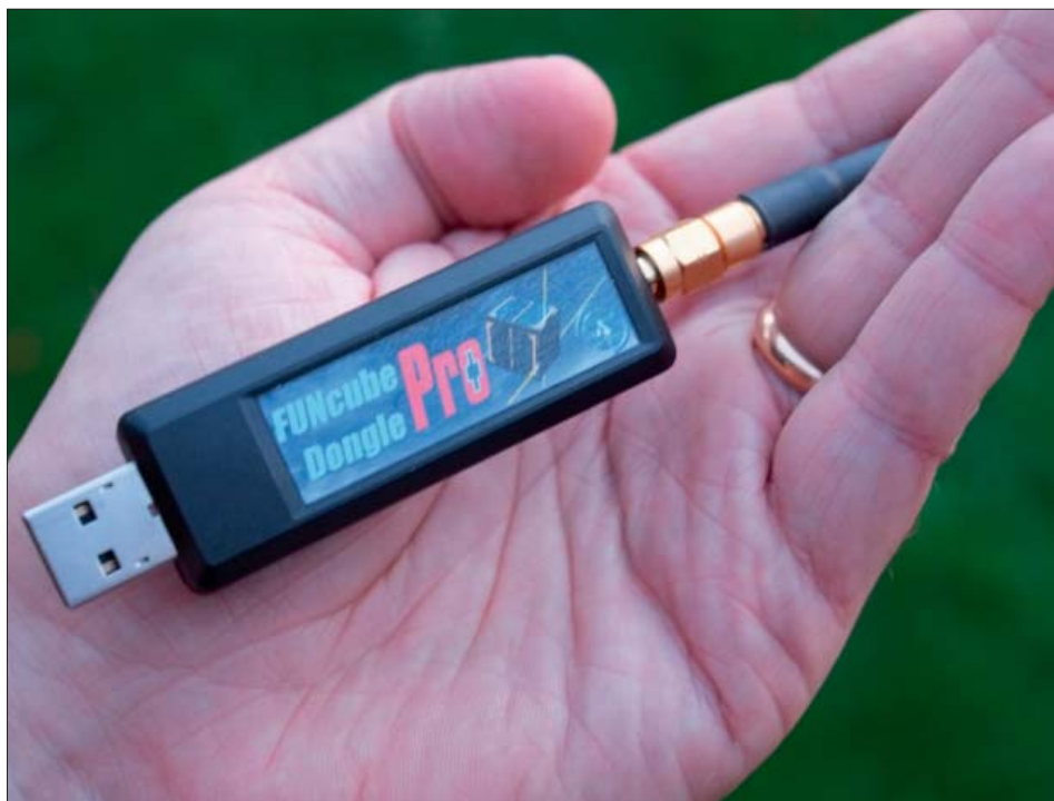
En hand full radio är allt som behövs för att ta emot mellan 150kHz och 2 GHz. USB i ena ändan till datorn och SMA-kontakt för att koppla in antennen. Låt dig inte luras av litenheten, den här är duktig som bara den.
